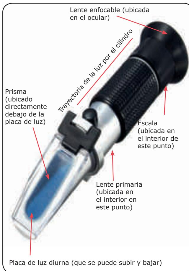
Refractómetro y sus partes
