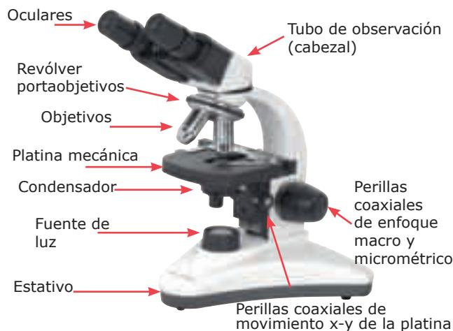
Microscopio y sus partes
