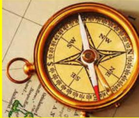
Instrumento para orientarse con aguja imantada, se usa para determinar el rumbo, señala el norte magnético.
